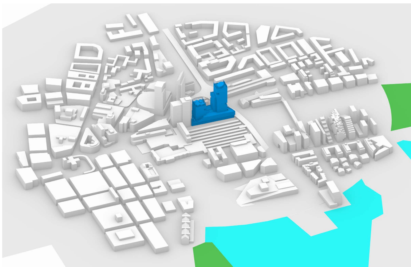
Figur 11. 3d-modell av Oslo Sentrum forenklet til CFD-simuleringer med planlagt bygg vist i blått.
